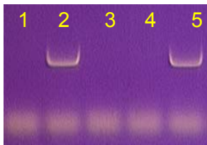
Abb. 6 PCR-Marker zum Nachweis des Lox-2 Allels aus Eunova . 1 = Annabell , 2 = Eunova , 3= Cree , 4= LP68 , 5 = Triumph
